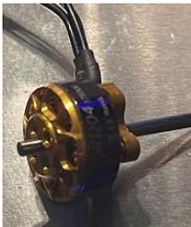
Die belgische Rennserie der BPC (<https://www.bpcorganisation.com/>) wechselt 2024 von Hawk7 Motoren zu Brushlessmotoren von GEPRC, GEP GR1204 3750kv. Der Motor wiegt 6,5 Gramm. Die ESCs sind eindeutig gekennzeichnet.
