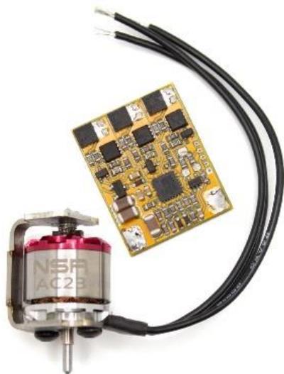
Die empfohlene Übersetzung ihrer Technik ist 5:40. Die Ankerwelle hat 1,50 mm Durchmesser. Der Rotor ist handgewuchtet und erlaubt dadurch extreme Drehzahlen ohne Vibrationen. Außer den Kugellagern gibt es keine Verschleißteile.
